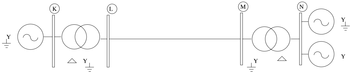
Figura 8.29: Diagrama unifilar del sistema trifásico balanceado
